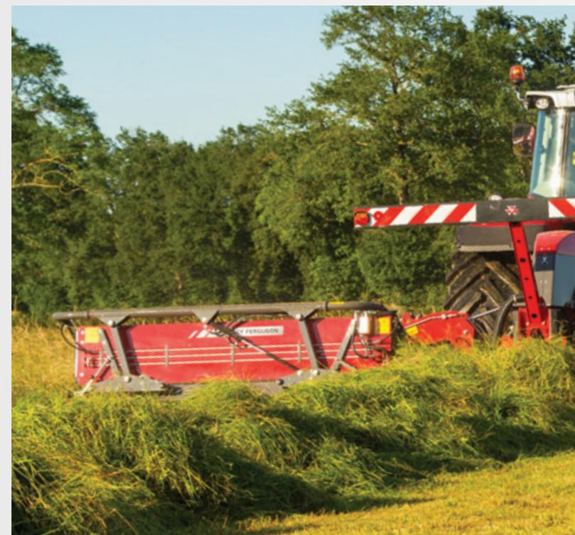
En cas d'incident, la faucheuse revient à sa position de travail sous son propre poids, pour gagner du temps sans avoir à reculer.
